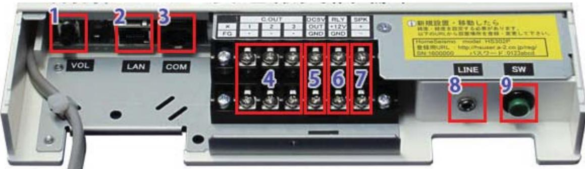
「9.SW（緑のスイッチ）」を押しながら電源プラグをコンセントに差込み、端末を起動します。
